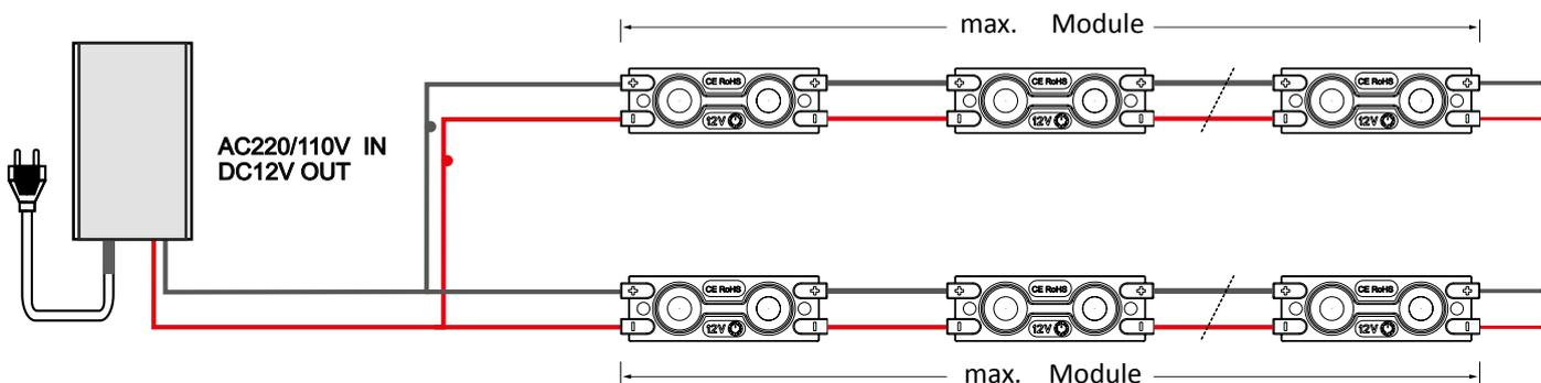
Anwenderfreundliche und Lichtstarke Modulketten, speziell für Ausleuchtung von Reliefbuchstaben und Leuchttransparenten mit geringer Bautiefe geeignet. Die Gehäuse sind auch für die Außenmontage geeignet (siehe IP-Schutzklassen).
