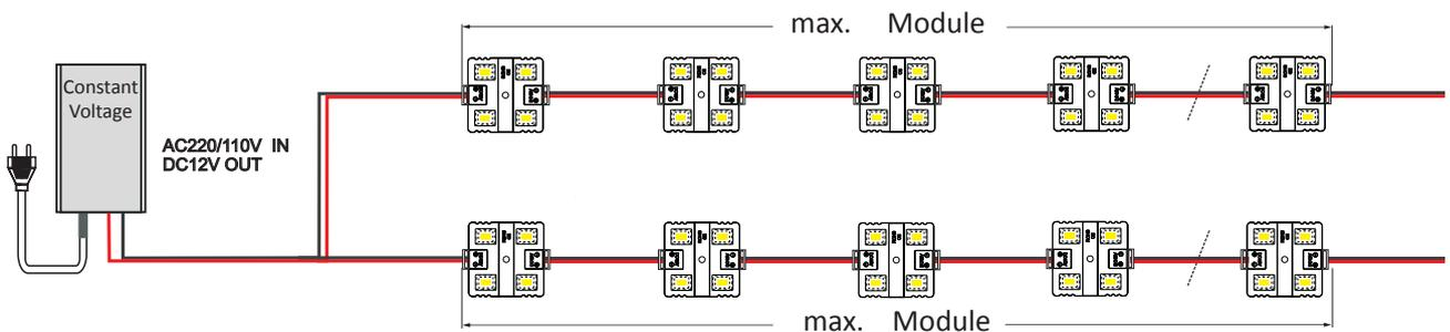
Anwenderfreundliche und lichtstarke Modulketten, speziell für Ausleuchtung von Reliefbuchstaben und Leuchttransparente geeignet. Die Gehäuse sind auch für die Außenmontage geeignet (siehe IP-Schutzklassen). In verschiedenen Farben erhältlich. Die Farbe des jeweiligen Moduls entspricht auch der Lichtfarbe.
