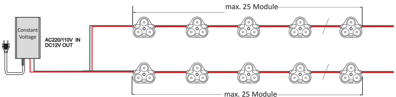
Anwenderfreundliche und lichtstarke Modulketten, speziell für Ausleuchtung von Reliefbuchstaben und Leuchttransparente mit einer Bautiefe ab 12 cm geeignet. Die Gehäuse sind auch für die Außenmontage geeignet (siehe IP-Schutzklassen).
