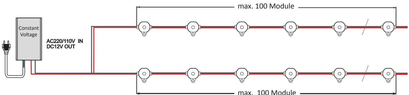
Anwenderfreundliche und lichtstarke Modulketten, speziell für Ausleuchtung von Reliefbuchstaben und Leuchttransparenze mit geringer Bautiefe (schon ab 4 cm) geeignet. Die Gehäuse sind auch für die Außenmontage geeignet (siehe IP-Schutzklassen).
